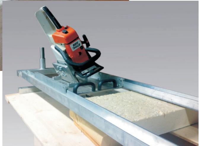
Der Schneideschlitten ist höhenverstellbar und herunterfallendes Material wird im passenden Au angehälter gesammelt. Eine zusätzliche Absaugung ist nicht nötig.
